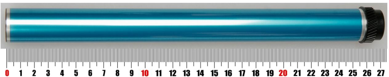
3. Покрытие на барабане прозрачное (свет отражается от алюминиевой поверхности барабана), это покрытие имеет при обычном освещении голубые оттенки. Общая длина барабана 273 мм.
